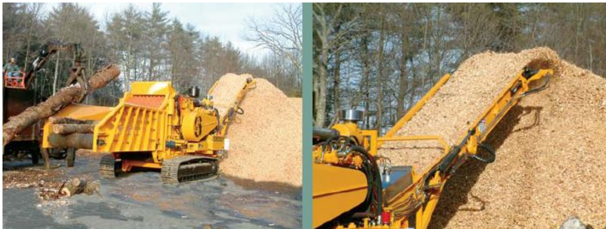
Производство чипсов согласно заданным размерам с производительностью до 200 тонн в час
